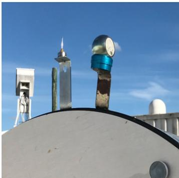
Figura 5. Señales de puntería adosadas al tubo del telescopio
