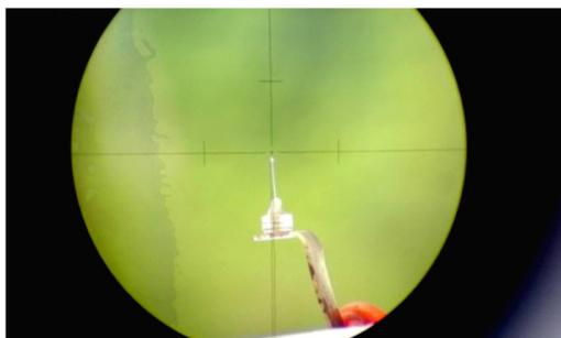
Figura 6. Imagen del apuntamiento a una de las señales, obtenida a través del ocular del teodolito.
