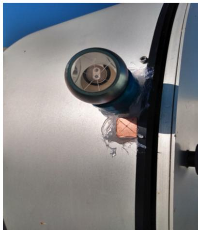
**Figura 9.** Señales colocadas en el telescopio (miniprisma y marca de puntería).
