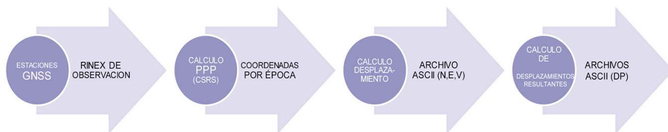
Figura 2: Procedimiento para obtener desplazamientos resultantes (DR) en estaciones GNSS.
