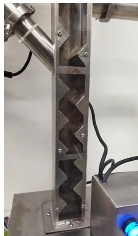
Figura 9. Equipo descascarillador en funcionamiento Fuente: autores
